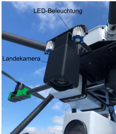
Abbildung 2.1: Aufbau des Systems auf der Drohne.
