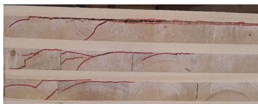
Abb. 9: Rollschubrisse (rot markiert) in den Querlagen [9]
