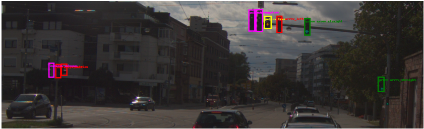
Abbildung 2: Die in Typ und Zustand klassifzierten Ampeldetektion. Die Farbe der Box entspricht dem Ampelzustand. Unbekannte Zustände sind in pinker Farbe gekennzeichnet. Am besten digital zu betrachten.
