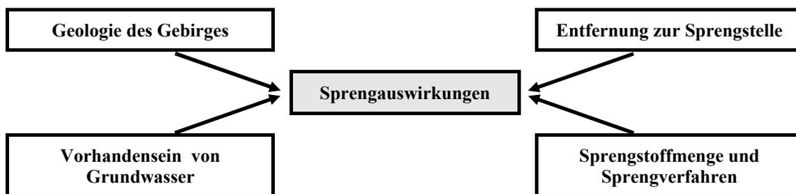
Bild 2.24: Einflussparameter auf Sprengauswirkungen
