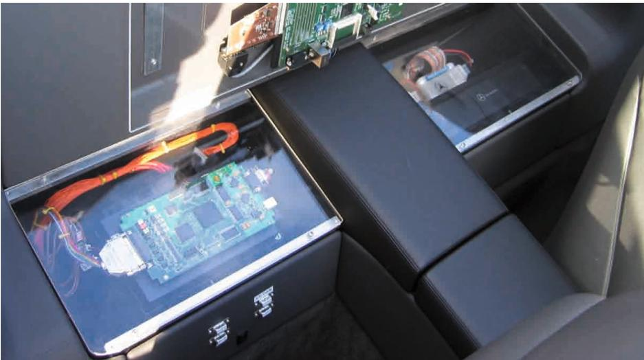
Abbildung 5.52: Fahrzeugeinbau Heck
