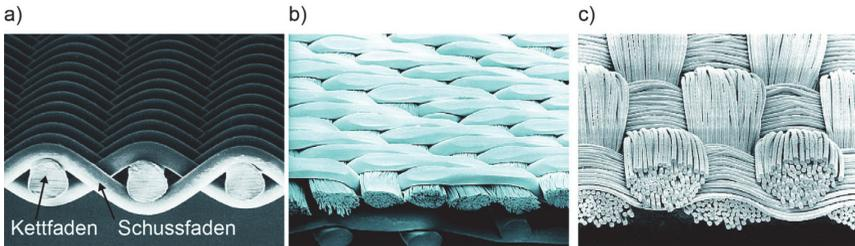
**Abbildung 4-3: Gewebearten, a) monofiles Gewebe, b) Doppellagen-Gewebe; c) multifiles Gewebe [Sefar-Verkaufsbrochüre]**
