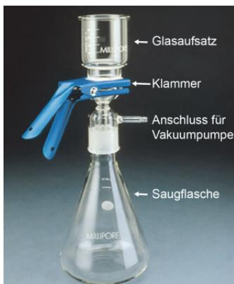
**Abbildung 5-8: Vakuumsfiltrationsgerät [Firma MILIPORE]**
