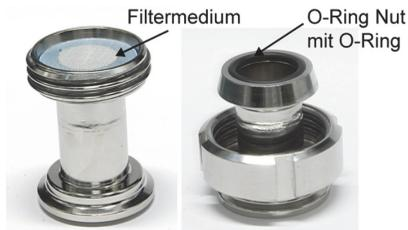
**Abbildung 5-2: Filterhalterung der Durchströmungsanlage, links: Gewindestutzen mit eingelegtem Filtermedium, rechts: Kegelseitenansicht mit O-Ring Nut und O-Ring**
