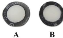
**Abbildung 4-8: Filtermedien mit Gummibelag (schwarz), A: Filtermedium PET-SK-22, B: Filtermedium PET-SK-12**
